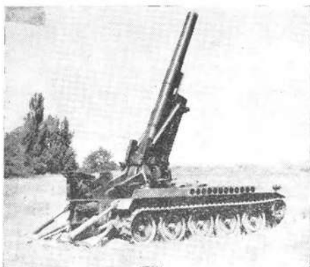
Figura 15-2 — Obús de 8 pulgadas T236 más liviano que el modelo standar, está diseñado para ser transportado por aire.
